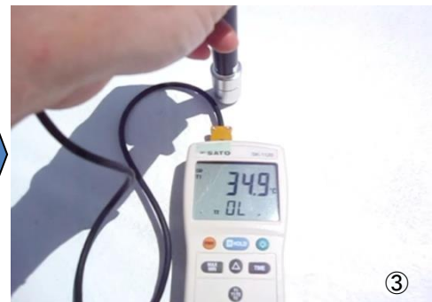
温度計を表面に当てるとすぐに2°C程度下がります。
