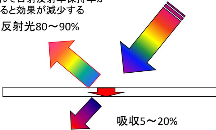
熱容量が小さいので吸収エネルギーで塗膜自体が温まってしまう
