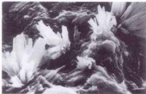
エトリンガイド(針状結晶) 電子顕微鏡写真(×7500)
